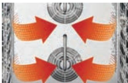
Konvektion (belüftet), für eine gleichmäßige Temperaturverteilung in der gesamten Kammer.
